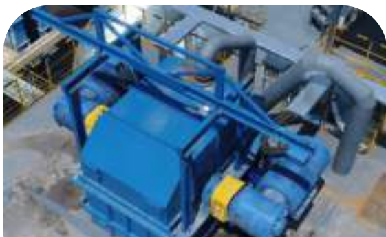
2×220kW 双驱板链式提升机【平邑中联】
