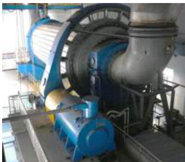
1400kW/10kV 煤磨直驱永磁电机【平邑中联】
