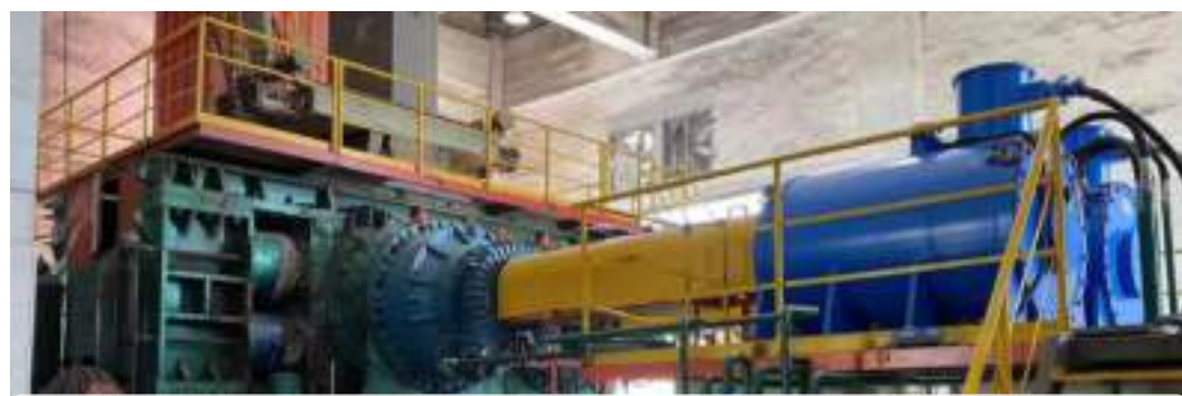
2 \times 1600\text{W}/10\text{kV} 水泥辊压机永磁电机【桃江南方水泥】
