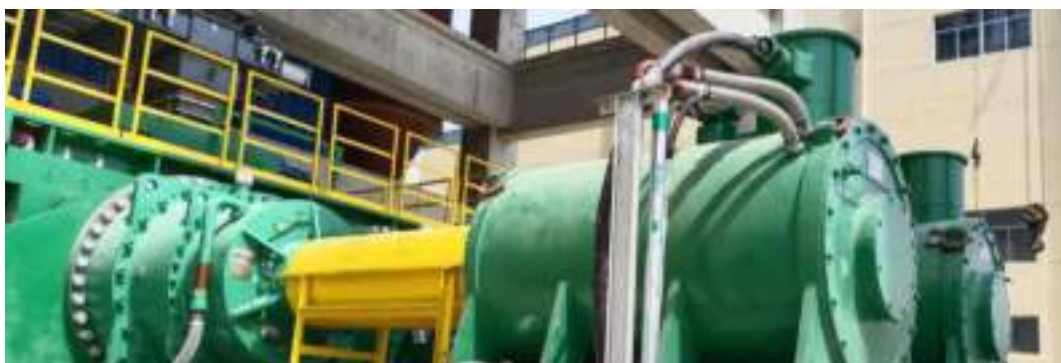
国内单台最大功率 2 \times 2400\text{kW}/10\text{kV} 生料辊压机永磁电机【平邑中联】
