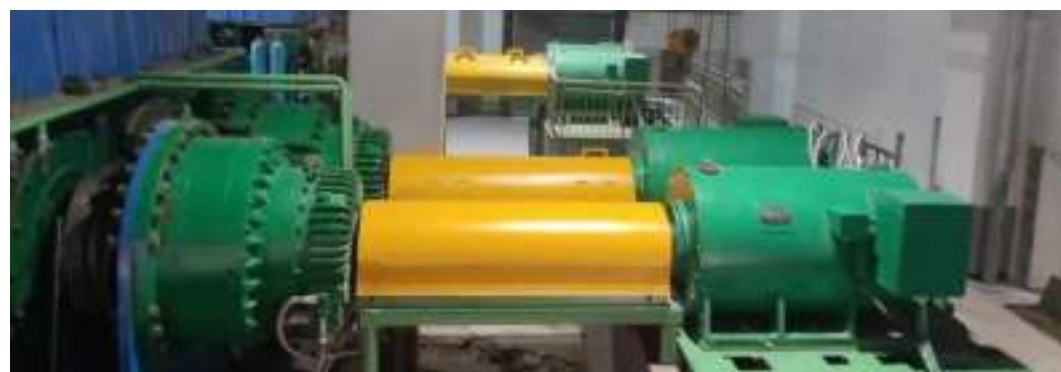
2 \times 1120\text{kW}/10\text{kV} 水泥辊压机永磁电机【平邑中联】
