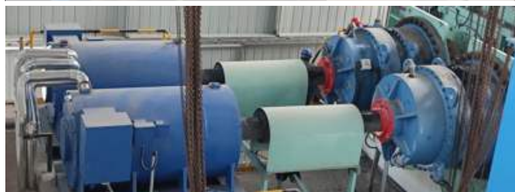
2 \times 1250\text{W}/10\text{kV} 水泥辊压机永磁电机【德通新材料科技】
